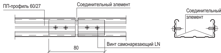
Соединение стоек ПП 60/27 по высоте
